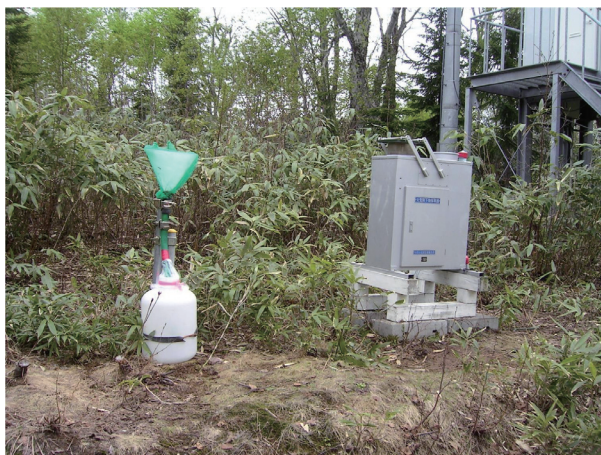
写真1. 林外雨(左)と湿性降下物(右)の採取装置 (416 林班山頂)
