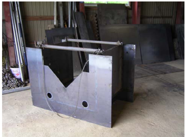
図-6 完成した量水堰
