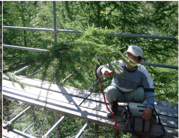
写真-2 林冠観測用足場 (5×7.3×12 (高さ) m)
