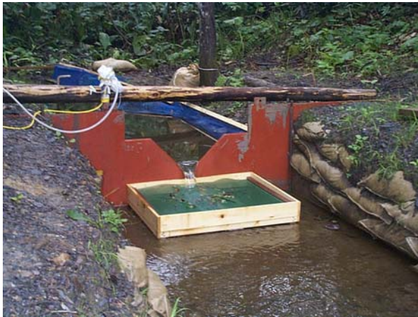
写真-1 量水観測堰 (7.5×1.2m)
