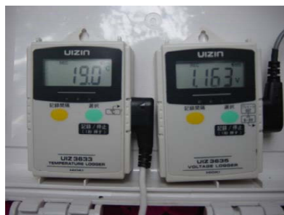
写真－2 地温計(左) 土壤水分計(右)
