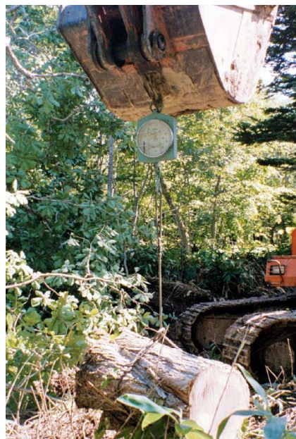
写真4 重機を用いた樹幹試料の重量測定
