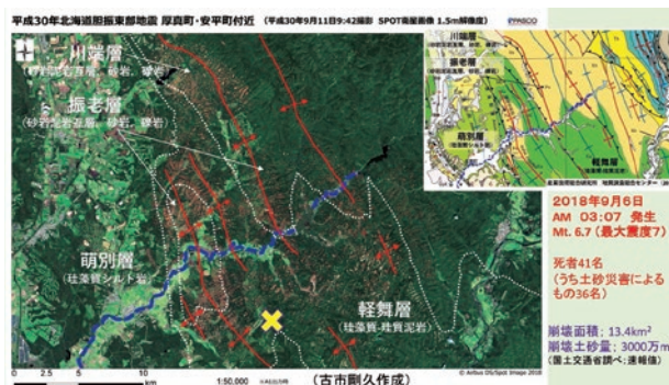
胆振東部地震に伴う斜面崩壊の発生状況（資料提供：小山内特任教授）
