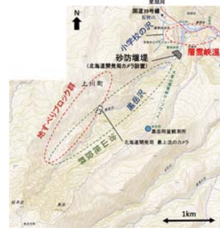
黒岳沢川第1号えん堤による土石流の捕捉(2016.8.23)
