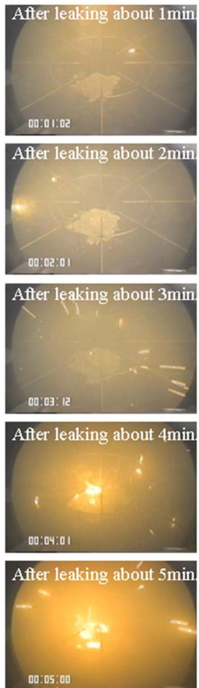
図 3- 14 漏えい初期のカメラ映像 (Case1)
