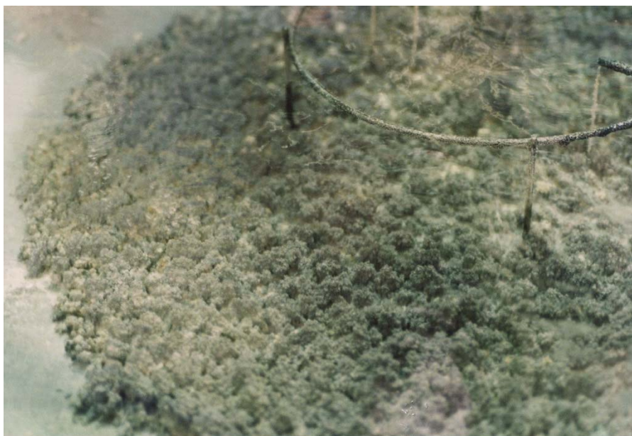
図 3- 13 プール表面のポーラス状ナトリウム反応生成物
