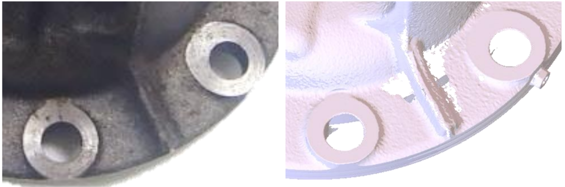
図 3.2 実際の鋳造品の表面（左）とその計測三角形メッシュの表面（右）
