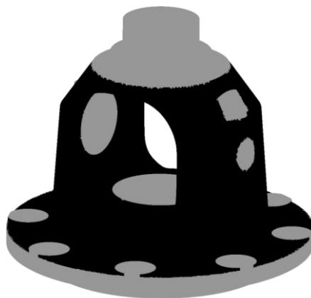
図 4.7 三角形メッシュへの鋳肌面・機械加工面情報の付与結果
