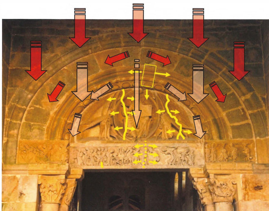
Fig. 9. Perrecy-les-Forges : schéma des pressions exercées sur le portail (© Sacleux). (En rouge les pressions principales sur la façade, en jaune : les fissures)
