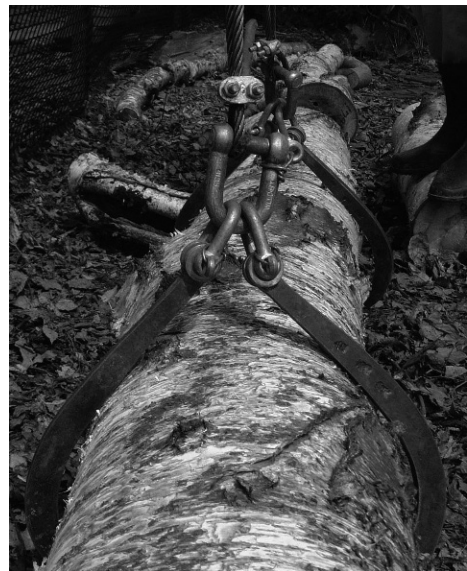
図 15. ディスク等研究資源を運搬するために自作した簡易運搬用具
