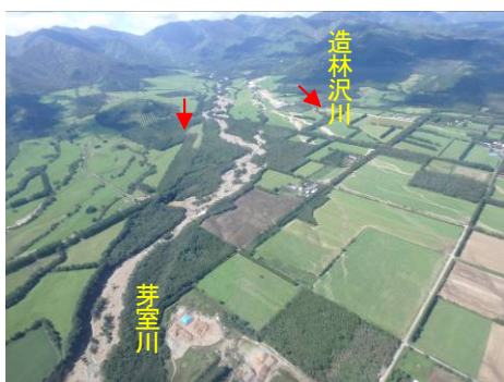
写真 j 芽室川の蛇行による側岸侵食 と造林沢川の土石流の氾濫 （上羽帯地区付近）
