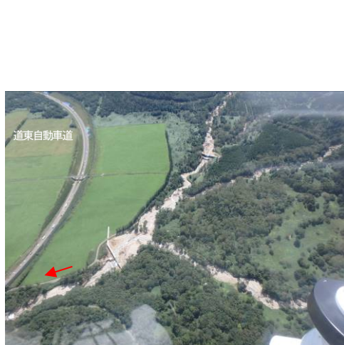
写真 c 砂防堰堤の土石流捕捉・土砂の調節状況（道東自動車道広内第二橋上流） 写真 d 下流の溪流保全工の状況
