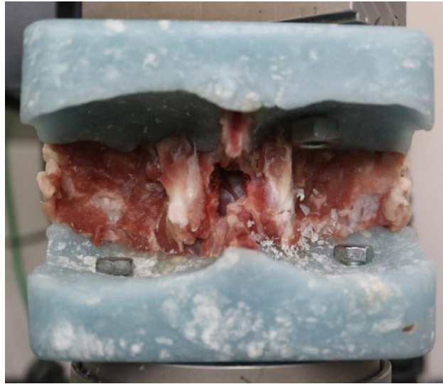
Figure 3. 上下を歯科用レジンで固定されたヒツジ腰椎椎体 - 椎間板 - 椎体分節
