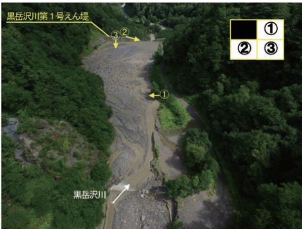
図-5 インターバルカメラ位置と画郭配置 Fig.5 Layout of the interval cameras
