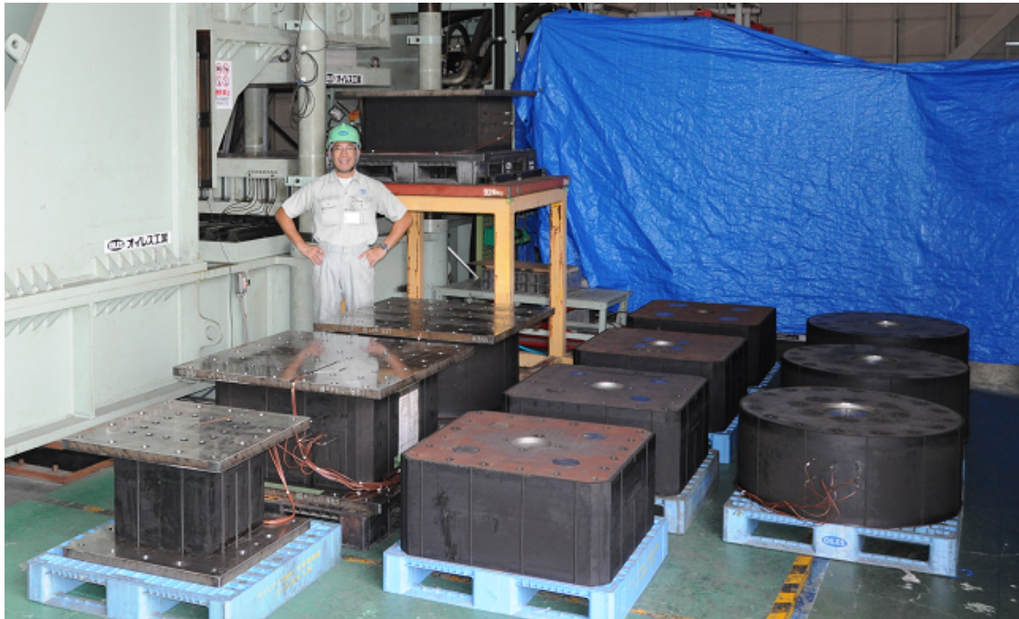
写真 4.1 3MN 二軸試験機と LRB 試験体
