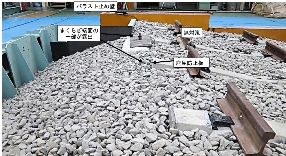
図 4.41 正弦波 9.0m/s 2 加振後の軌道模型の状態（横方向荷重 4kN）
