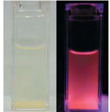
図2 金ナノ粒子溶液の写真 左:太陽光下 右:紫外下
