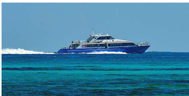
図 補.3-7 高速船（全長 33.20 乗客能力 188 人 最高速度 40 ノット ウォータージェット×3 セット）（出典： https://www.yaeyama.co.jp/ships.html ）
