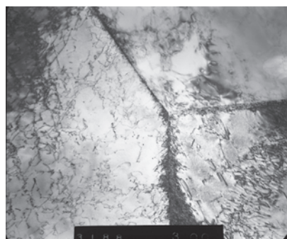
図5 Inlite II-532 の電源を入れる前(左)とレーザー発振時(右)のステンレスの H-1300 像 (30,000 倍、像のブレや歪みは観察されない)
