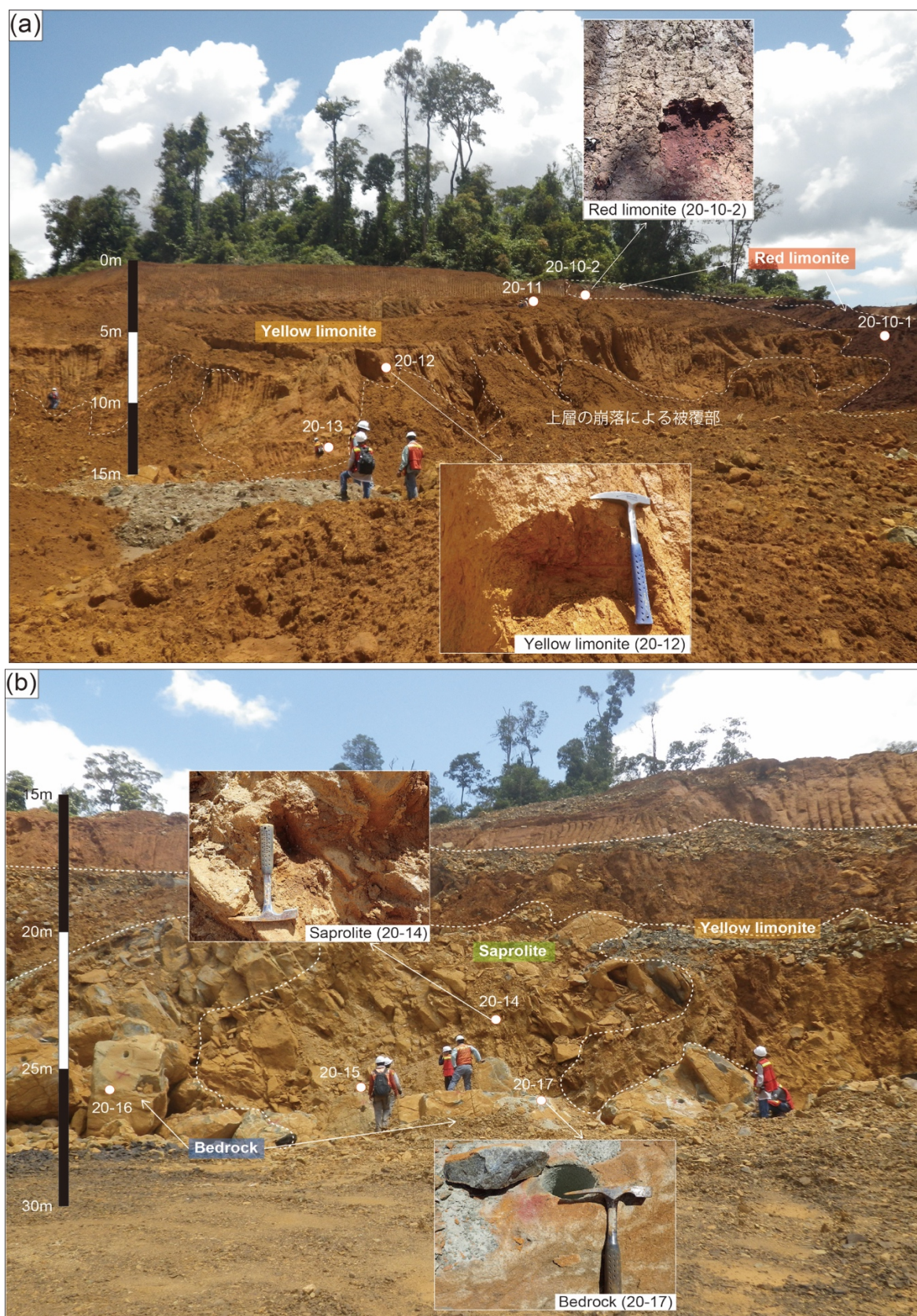
Fig. 4.6 Konde Hill の (a) Limonite 層の断面の様子と試料採取位置 (20-10-1 から 20-13) および代表的な試料写真, (b) Saprolite 層以下の断面の様子と試料採取位置 (20-14 から 20-17) および各層の代表的な試料写真.
