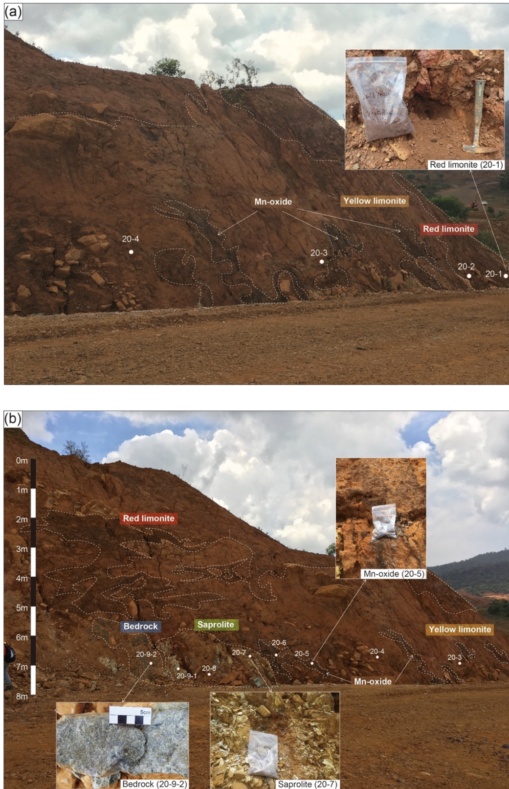
Fig. 4.5 Figure 4.5 Watulabu Hill の (a) Red Limonite 層の断面の様子と試料採取位置 (20-1 から 20-2) および 代表的な試料写真, (b) Yellow Limonite 層以下の断面の様子と試料採取位置 (20-3 から 20-9-2) および各層の 代表的な試料写真.
