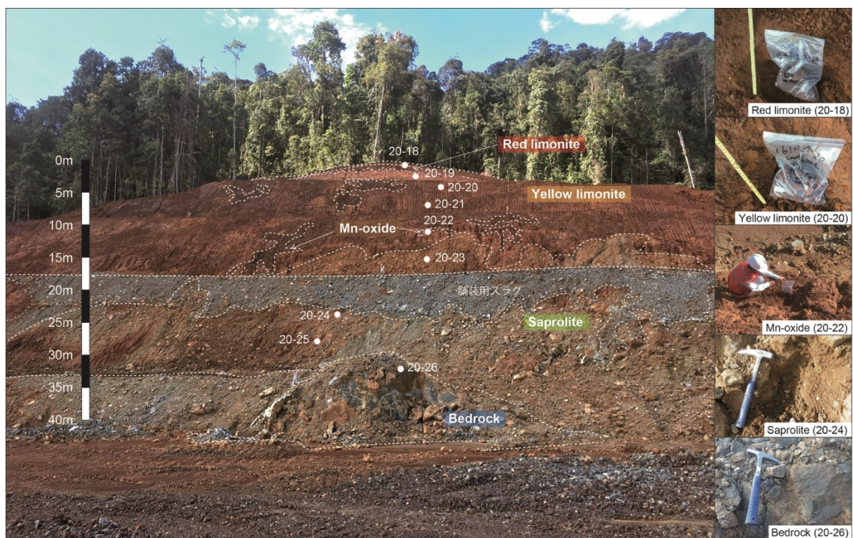
Fig. 4.7 Petea Hill の断面の様子と試料採取位置および各層の代表的な試料写真.
