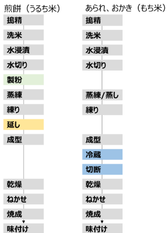
Fig. 2-1. 米菓の一般的な製造工程の流れ. 一般に煎餅には製粉と延し工程、あられ・おかきには冷蔵と切断工程が存在する.
