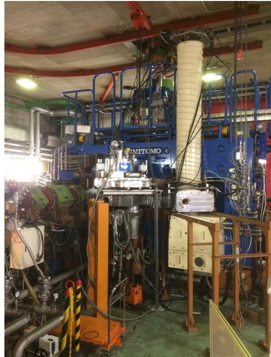
図 3-1 ビーム最下流に設置された標的容器（左）と AVF サイクロトロン（右）
