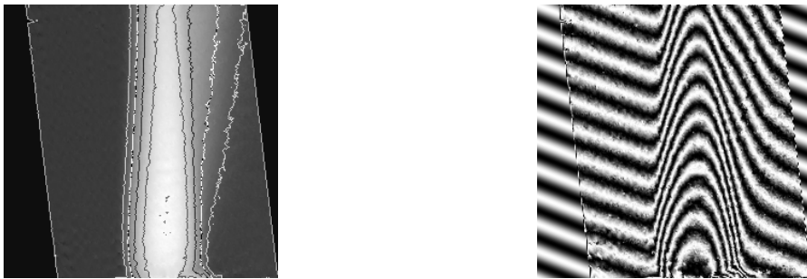
図 3.4: 変形処理により不自然な位相の段差が生じた位相変化像 i_{\text{seed}}(\boldsymbol{r}) と, i_{\text{seed}}(\boldsymbol{r}) から生成された干渉画像の例.位相変化像の等高線は 2\pi[\text{rad}] ごと.
