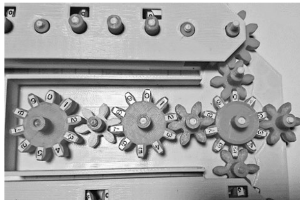
図 4. 10 進歯車と 2 進・16 進歯車との連結部分の機構
