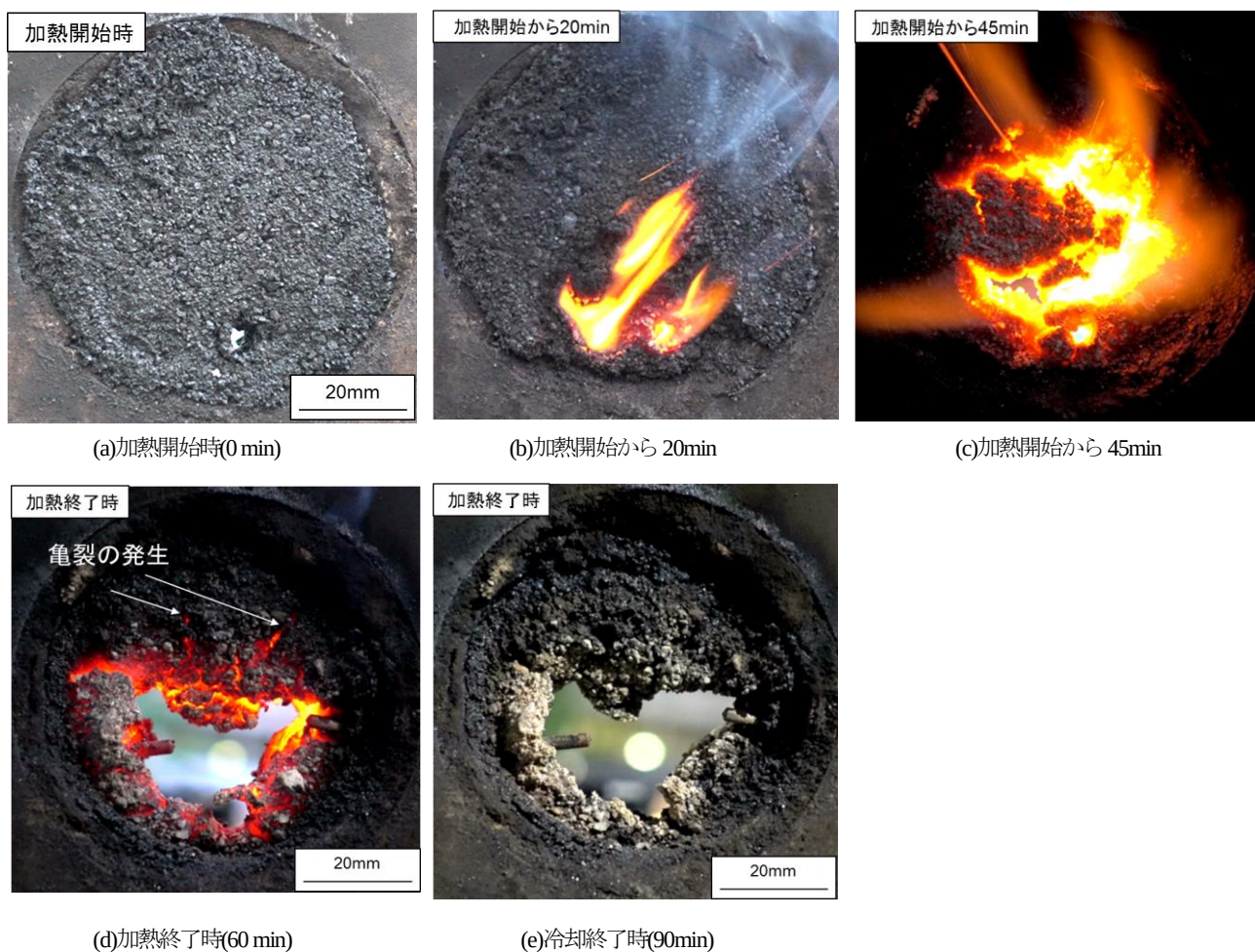
図7 供試体C(貫通型)の観察面の様子
