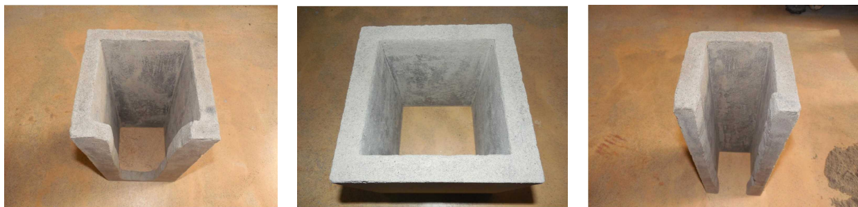
図 5.4 実験後の地盤改良壁の状況
