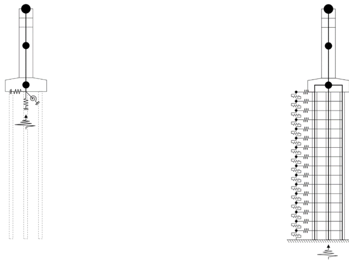
(a) 低減した杭反力を一義的にフーチングに集約 (b) 地盤～杭基礎系の応答挙動を考慮
