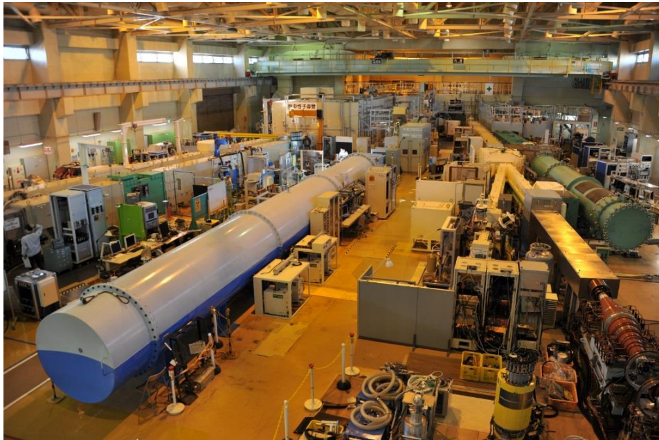
図 1-1 JRR-3 ガイドホール内の様子、SANS-U（左側の水色の装置）と SANS-J-II（右側の緑色の装置）
