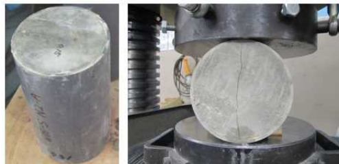
図-6.4.1 コンクリート円柱供試体の割裂載荷によるひび割れ導入状況
