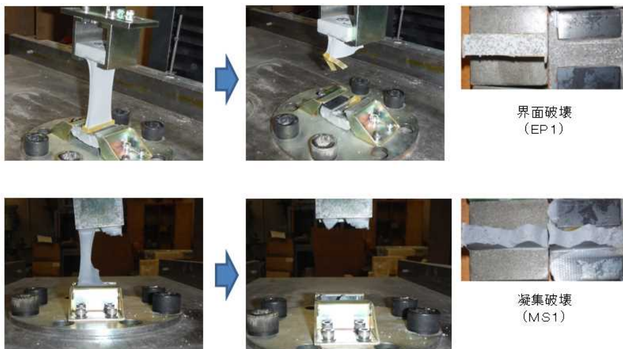
図-5.3.2 接着引張試験時のH型供試体の破壊状況例
