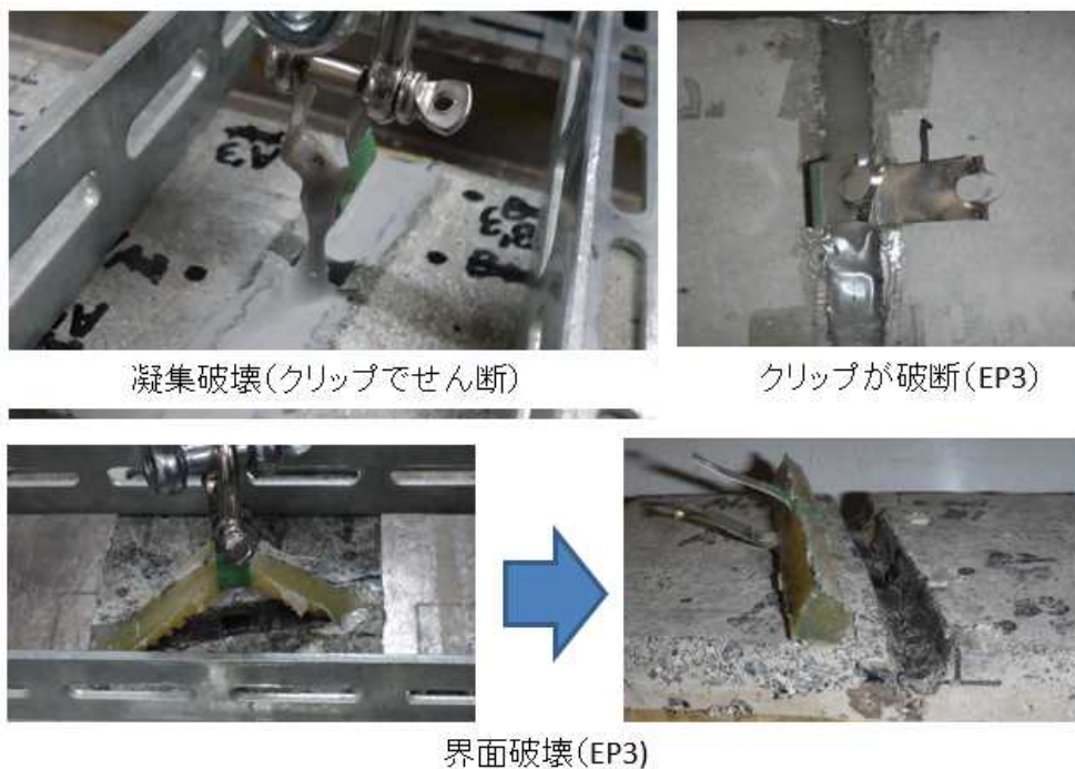
図-5.3.3 接着引張試験時のクリップ充填供試体の破壊状況例
