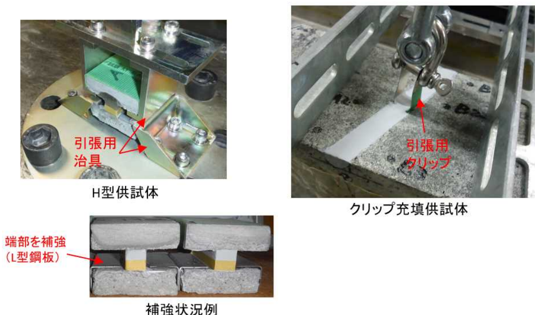
図-5.2.4 接着引張試験状況
