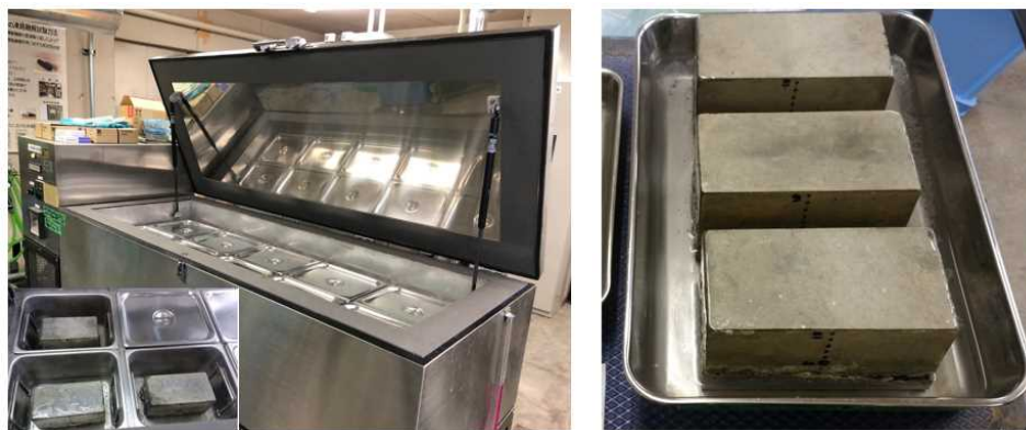
図-2.3.3 CDF 試験装置と試験状況
