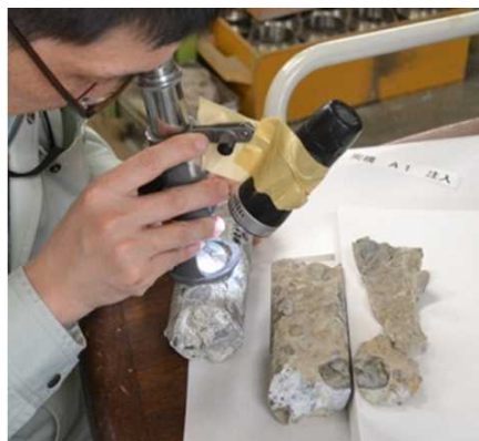
図-7.3.1 コア側面の測定状況
