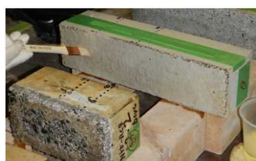
浸透系塗布材の塗布状況
