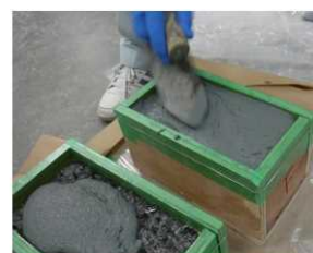
断面修復材（厚さ15mm）の施工状況 （SBR系ポリマーセメントモルタル）
