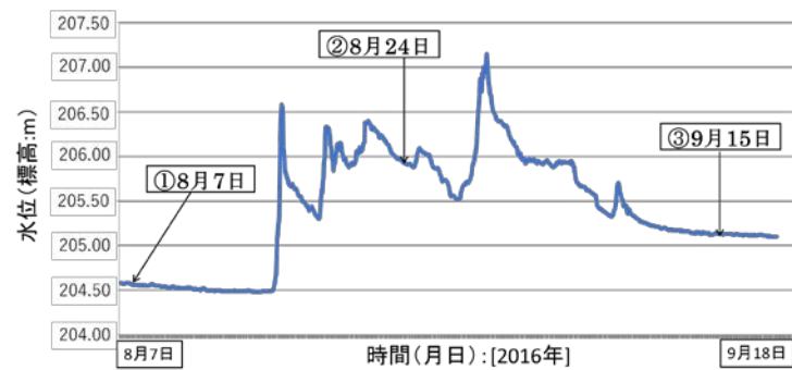
図 3-2 音更川土幌水位観測所水位ハイドログラフ(北海道開発局提供, 暫定値) [2016年8月7日～9月18日, 図中の日付はと図 3-3 に対応]
