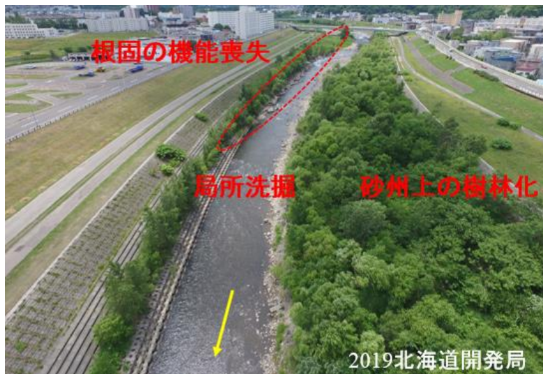
(a) 砂州上の樹林化と局所洗掘箇所の様子
