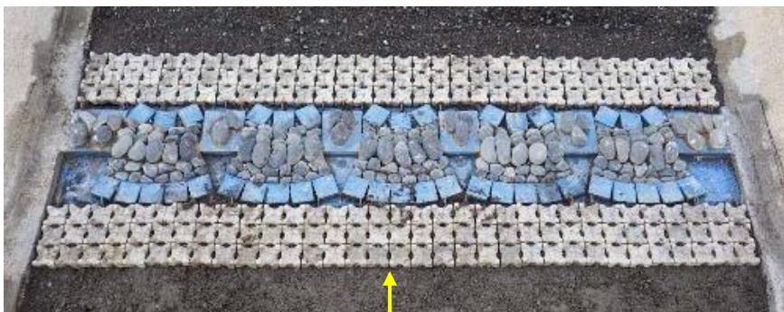
図 3.6 現地で施工された石組構造の帯工を縮尺1/40模型で再現
