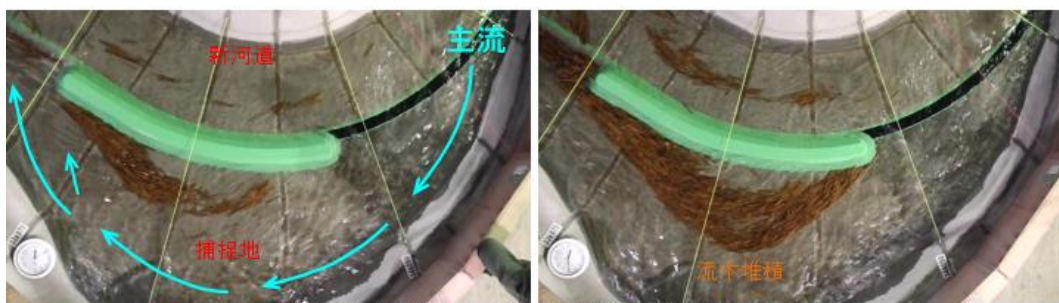
図 6.4 流木の挙動と堆積過程 (流量 Q=680\text{m}^3/\text{s} , 流木長 L=6\text{m} )
