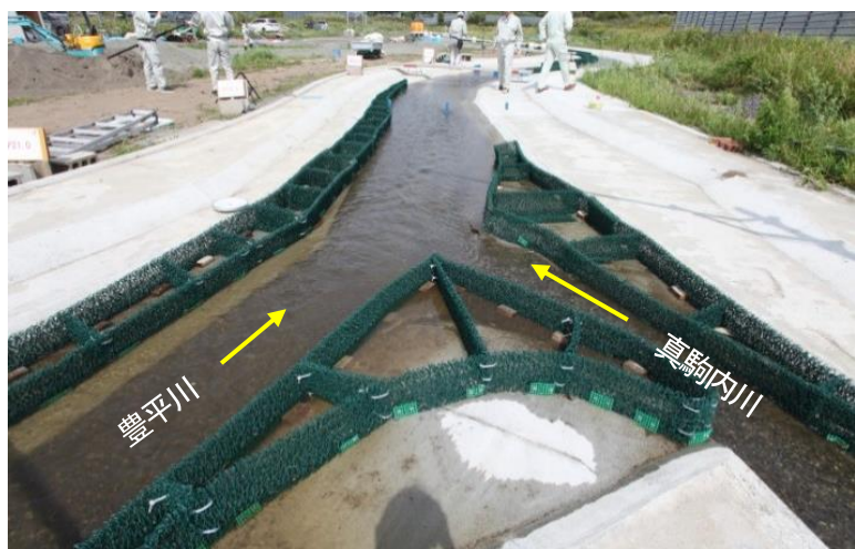
図 3.5 真駒内川合流点付近の模型実験の様子
