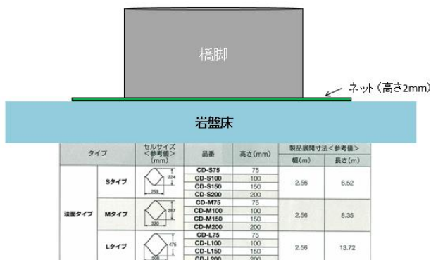
図 4.7 橋脚周辺の岩盤侵食対策の考え方
