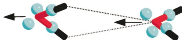
図6：準安定な水分子2量体の構造。青い球はWFC。矢印はそれぞれの分子の電気双極子モーメントをあらわす 15) 。
