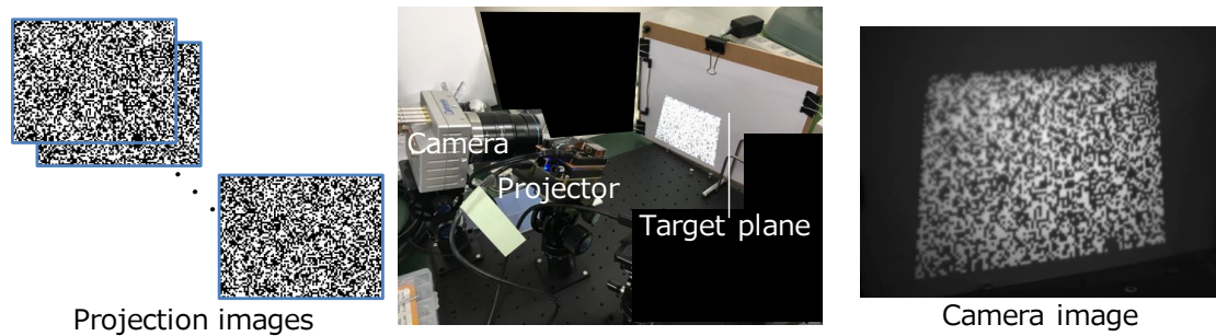
図3.4 平面に対する復号化実験の系．ProCam と計測対象物である平面があるシーン．複数のランダムパターンを投影&撮影する．右のような，撮影画像が得られる．
