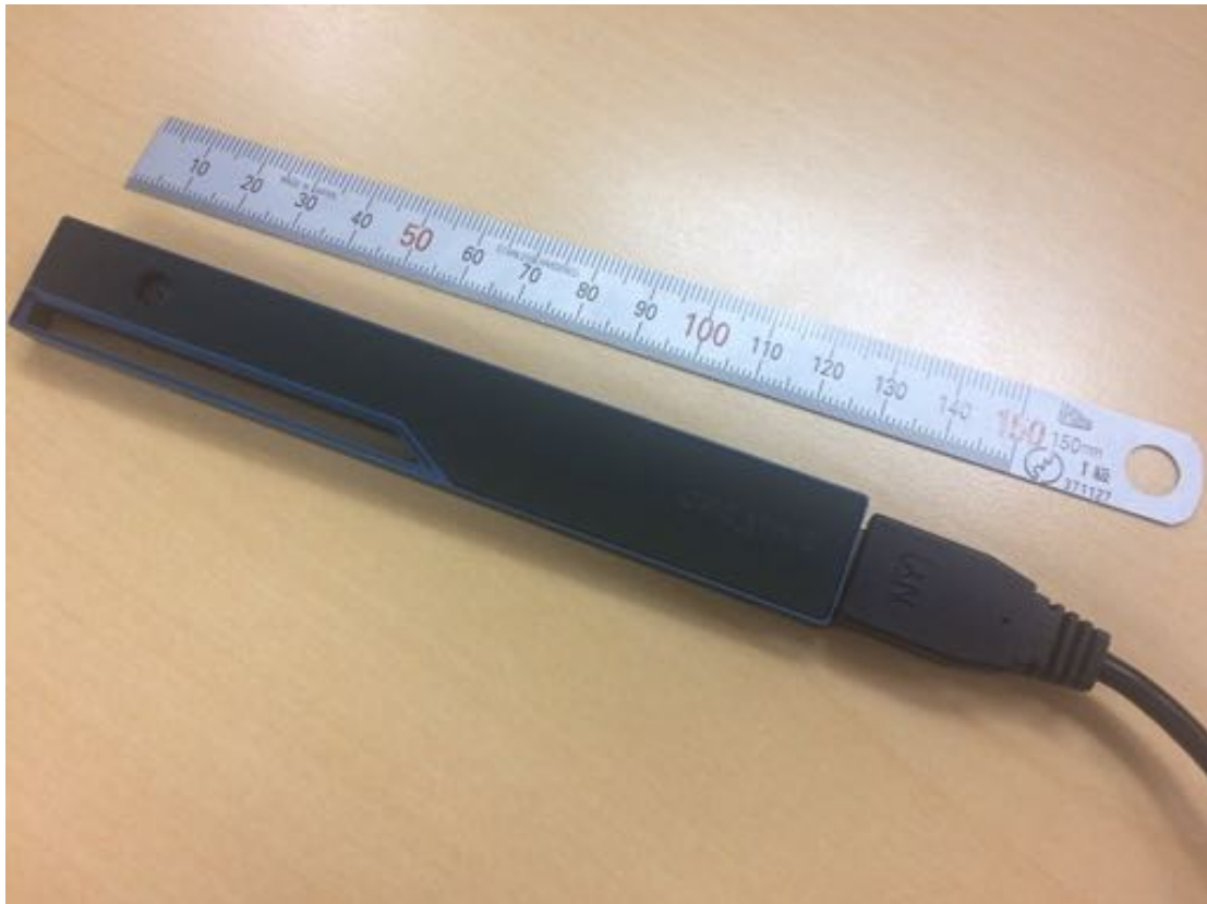
図5.13 RGBD センサ : Intel RealSense R200. (Copyright(C)2019 IJAT, [45] 図 12)
