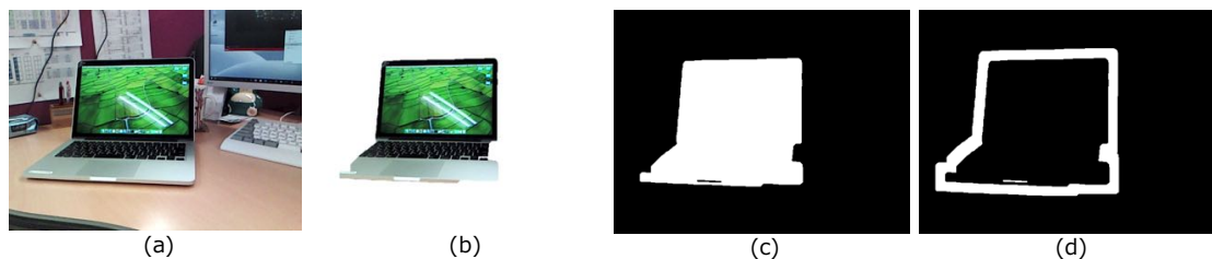
図5.8 ラップトップ PC の拡張エッジ領域の計算法：(a) は入力画像．(b) は YOLO を用いて検出されたオクルーダ（ラップトップ PC）のシルエット．(c) はシルエットの二値化画像．(d) はシルエットのエッジを拡張した領域である，拡張エッジ領域．(Copyright(C)2019 IJAT, [45] 図 7)
