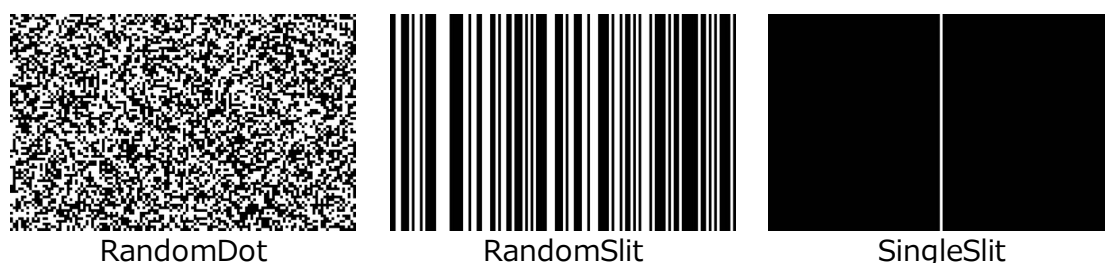
図4.6 実験に用いた投影パターン．左：ランダムドットパターン（提案法），中：ランダムスリットパターン（提案法），右：シングルスリットパターン（既存法）
