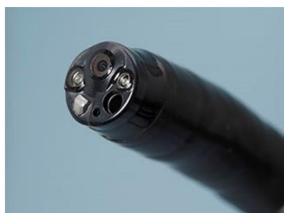
図4 エンドサイトスコピー市販型、先端部分 (スコープ径 9.7mm)。
