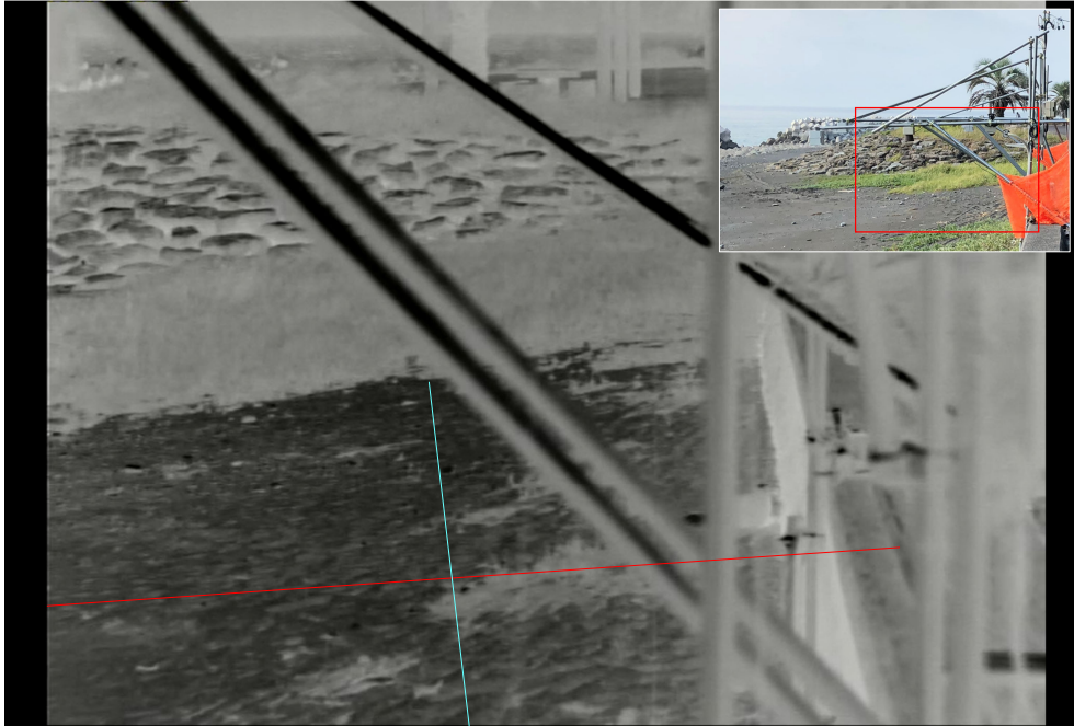
図 5.8 晴天時の遠赤外線カメラの画像例と検査線 (図中、赤線が岸沖方向、水色線が沿岸方向の検査線を示す)
