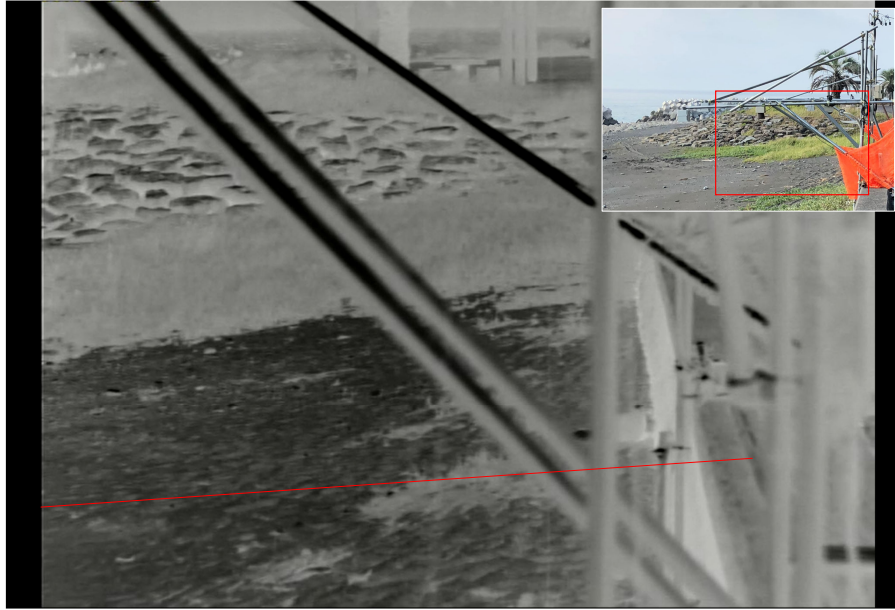
図 3.15 晴天時の遠赤外線カメラの画像例と検査線（図中、赤線）
