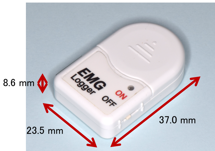
図2 超小型ウェアラブル筋電計
