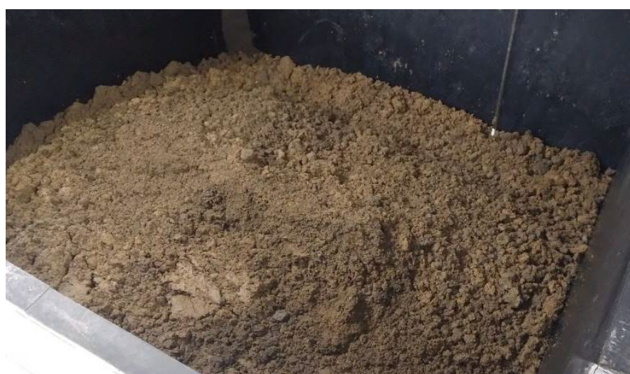
図 5-4 実際に処理される汚泥の外観
