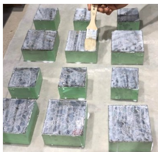
(a) Application of primer
