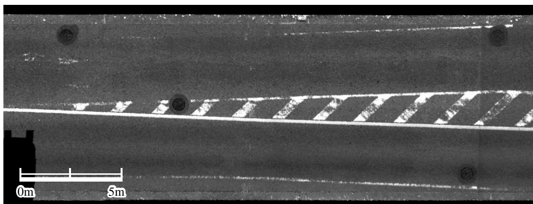
図 3.25 区間 1 における点群の反射強度表示
