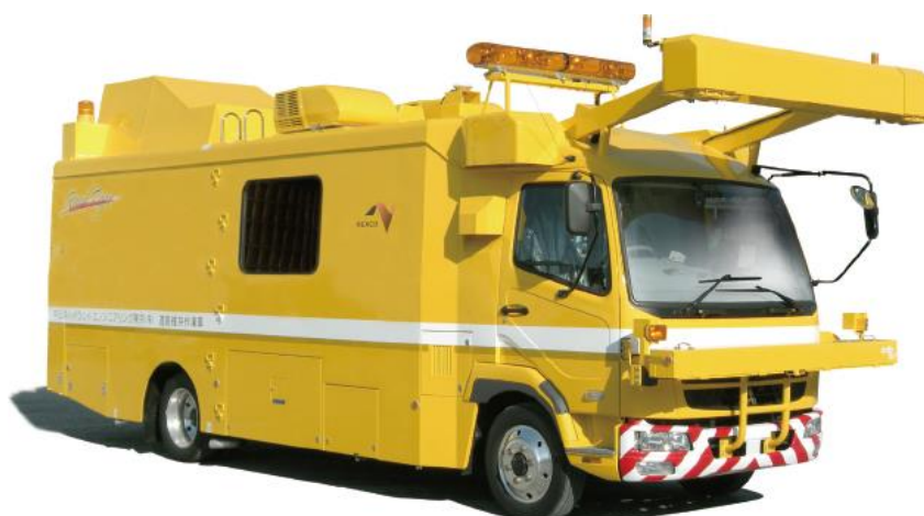
図 1.30 路面性状調査車両[52]
