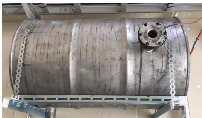
図 2.13 吸気サージタンク及び丸形ノズル
