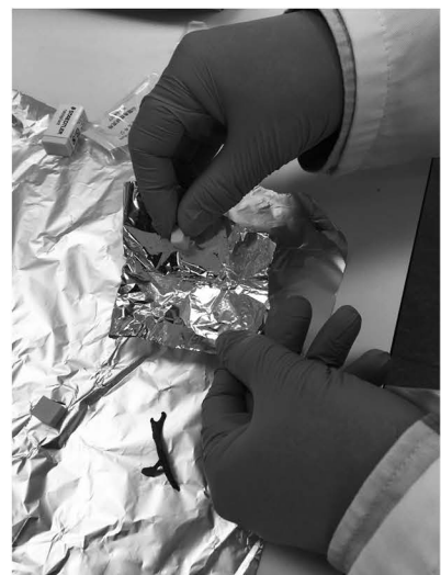
消しゴムを用いた「微破壊」サン プリング
