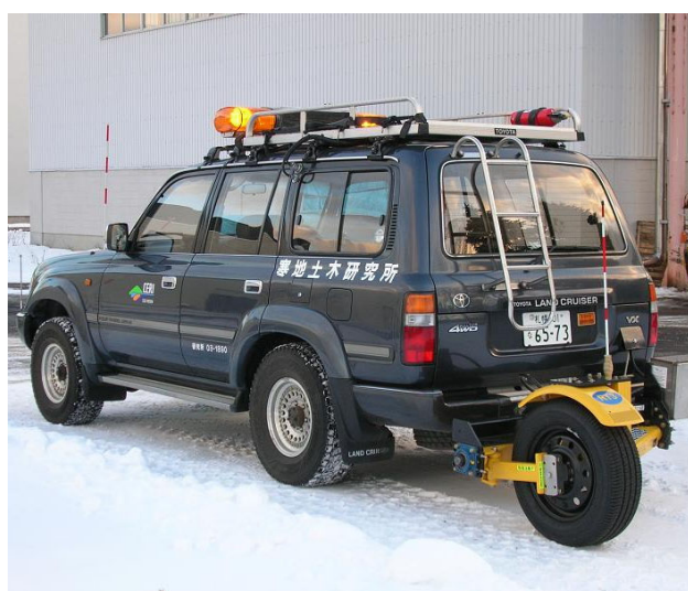
図 1.21 連続路面すべり抵抗値測定装置 (CFT) 外観 (左) と測定概念図 (右)
