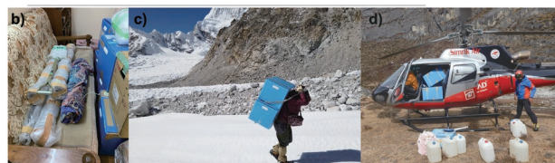
図4：(a) 掘削関係の主要な荷物の一覧を示した。全ての荷物はポーターによる輸送を想定し、1個が40kg未満になるように準備した。発電機用のガソリンはヘリコプターへの搭載が不可のためポーターによる輸送をおこなった。(b) 重量・容量制限のために、ケースから取り出され、現地で調達した毛布などで再梱包された掘削機材（撮影者：江刺和音氏）。(c) ポーターによる物資運搬（撮影者：藤田耕史氏）。(d) ヘリコプターに積まれた掘削機材（撮影者：佐藤洋太氏）。Tsushima et al. (2021) に加筆。
