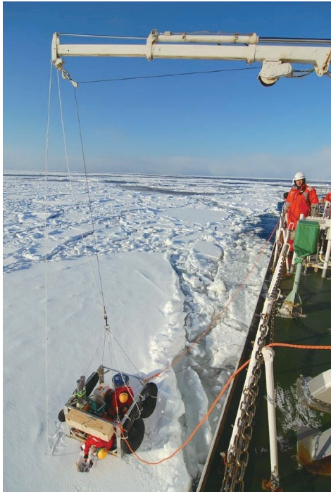
図9：バスケットを用いて海水や積雪のサンプリングをしている様子
