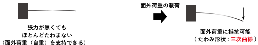
図-4.3.1 幾何剛性の例：糸と針金の場合
