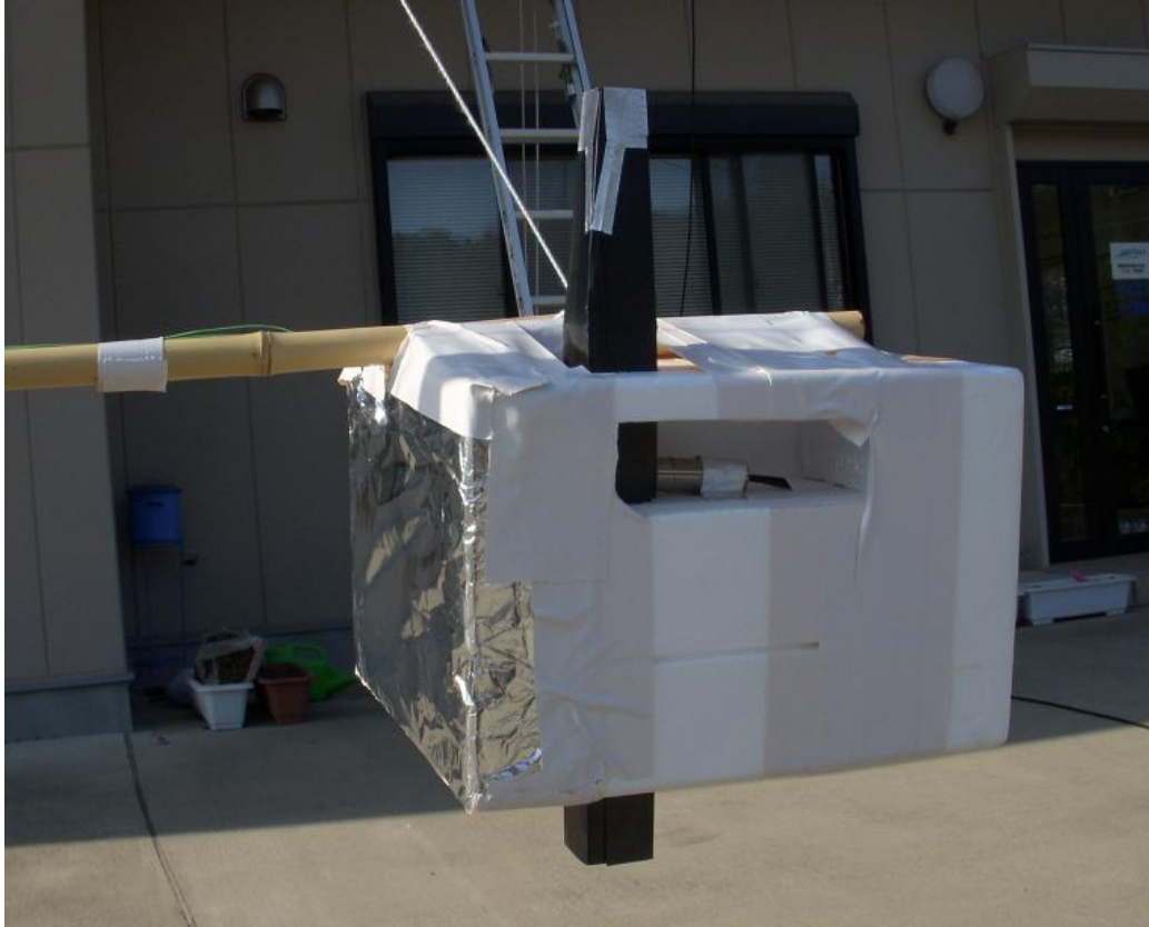
図 6.2 飛揚直前のゾンデ版 FINEDEW。電波干渉防止のため、アルミホイルを貼り付けている。
