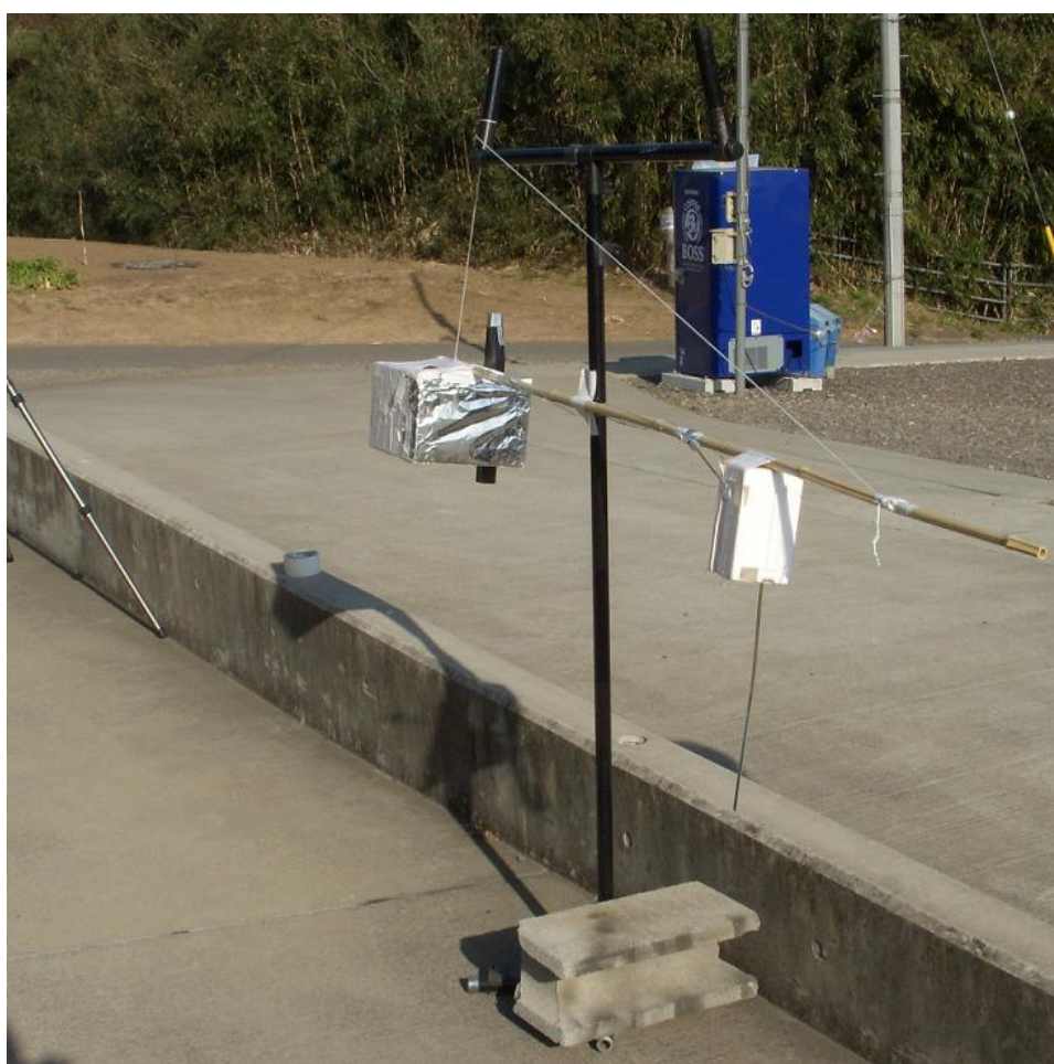
図 6.1 飛揚直前の装置。手前がラジオゾンデ RS-06G(明星電気株式会社製)、奥がゾンデ版 FINEDEW。電波干渉防止のため、RS-06G とゾンデ版 FINEDEW™ の距離を離している。
