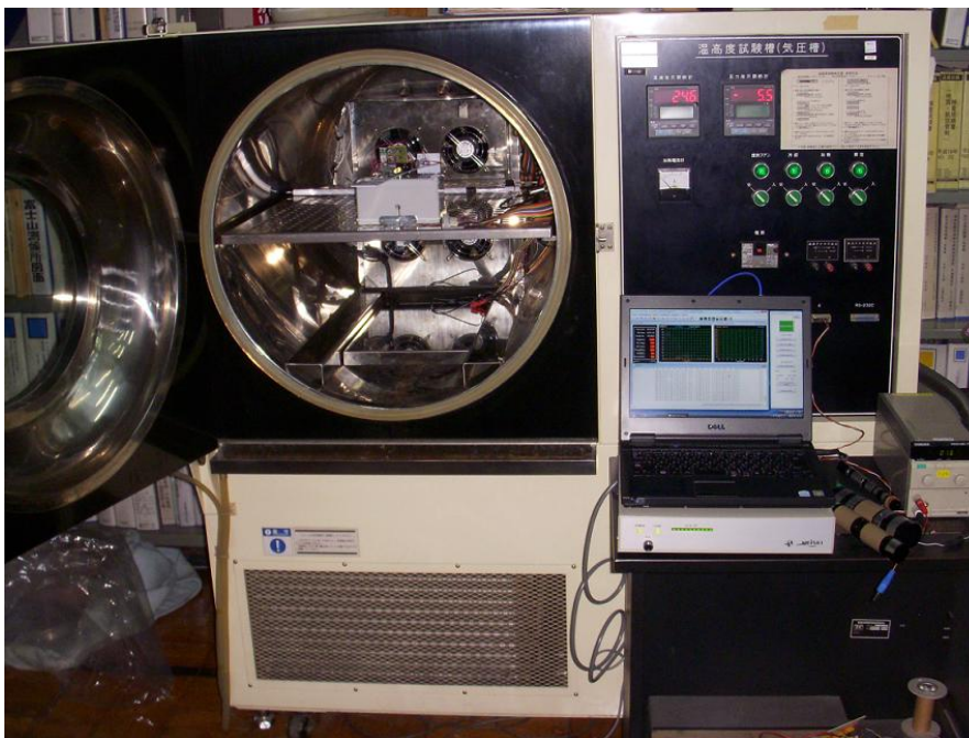
図 5.11 風速計測実験の様子(上:筒内のサーミスタの取り付け、中:回転台、下:気圧槽内での実験)
