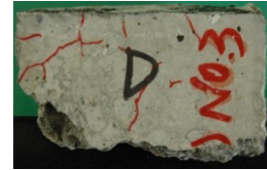
(d) ASR cracks on the "B" part
