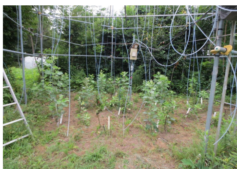
写真 1. 実験苗畑にオゾン付加区と対照区を各 3 基ずつ設置された開放系オゾン付加施設
