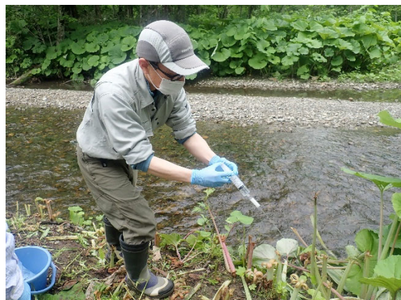
写真 4：環境水のろ過作業の様子
