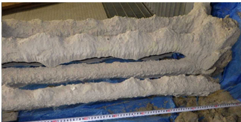
Fig. 2-3 実機曝露試験後の腐食プローブ外観（排ガス平均温度：685°C）
