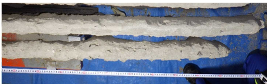
Fig. 2-4 実機曝露試験後の腐食プローブ外観（排ガス平均温度：565°C）
