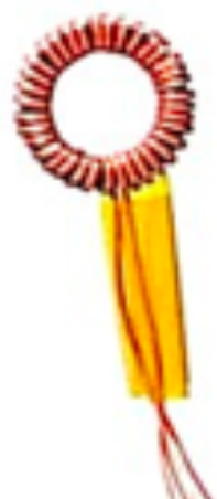
図 5.3: 圧粉磁芯で生成されたトロイダルコア [33]
